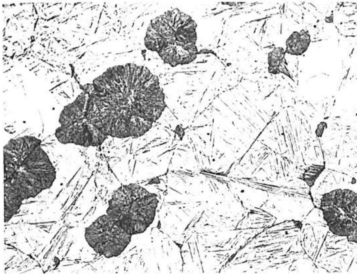
شکل ۲-۶ سطح مقطع کره‌های پرلیت (سیاه‌رنگ) در فولاد یوکتوئیدی. زمینه، آستنیت تبدیل نشده به پرلیت است که در اثر سریع سرد شدن به مارتنزیت تبدیل شده است. بزرگ‌نمایی 250\times [۱].
