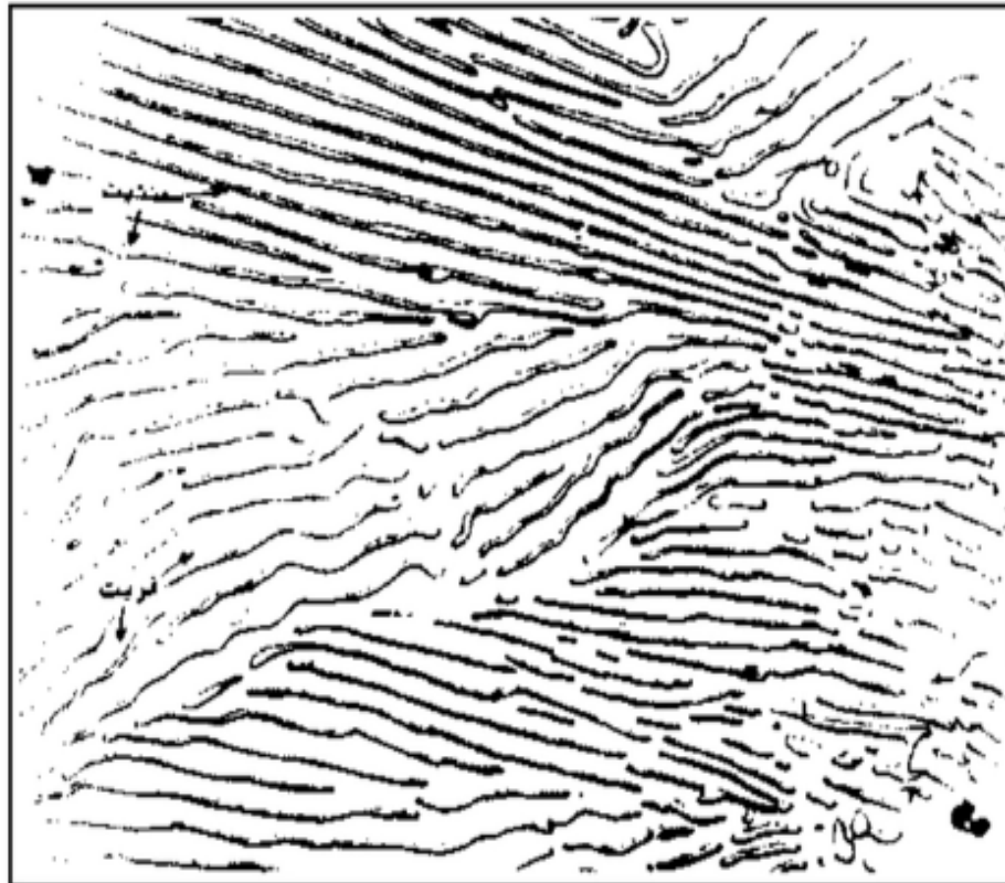
شکل ۲-۳ پرلیت شامل لایه‌های سمیتیت در زمینه‌ای از فریت، بزرگ‌نمایی \times 2500
