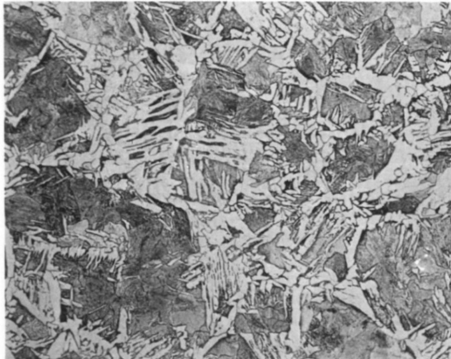
شکل ۲-۱۵ ریزساختار فریت پرویوتکتوئید در قالب صفحه‌های ویدمن‌اشتاتن در فولاد ۰.۴٪C-Fe. محلول حکاکی نایتال، بزرگ‌نمایی \times 2000 [۱].
